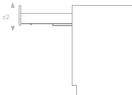
Дополнительная регулировка ящика по высоте при помощи замков.
