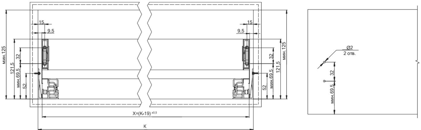
**МОНТАЖНЫЕ РАЗМЕРЫ ЗАДНЕЙ СТЕНКИ ЯЩИКА**
